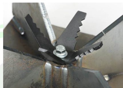
PIRANHA kések - dupla aprítás - tömörebb apríték
